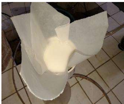
Pencucian Zr^{4+} -Zeolit Beta dengan aquademin sampai bebas ion Cl^-
