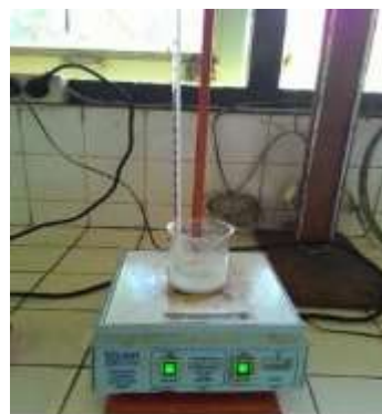
Pencampuran \beta -siklodekstrin terasetilasi dengan etanol 70%
