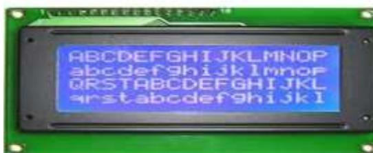
Gambar 2.6. Modul LCD 16x4
