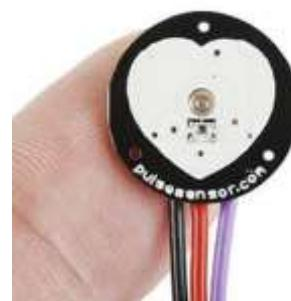
Gambar 2.4 *Pulse sensor* atau sensor detak jantung
