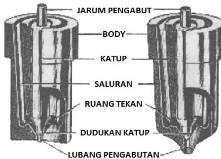
Gambar 2.25. Nosel Injeksi Tipe Lubang Sukoco dan Zainal Arif, Teknologi Motor Diesel, 2008:108
