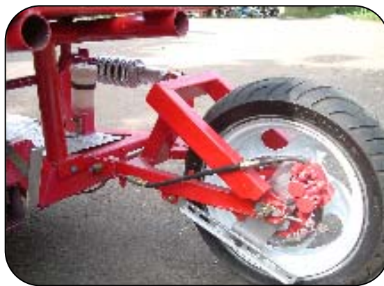
Gambar 19. Konstruksi sistem suspensi belakang Micro Car bagian kanan
