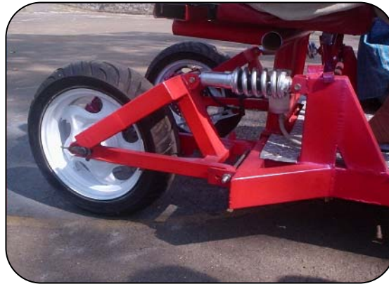
Gambar 20. Konstruksi sistem suspensi belakang Micro Car
