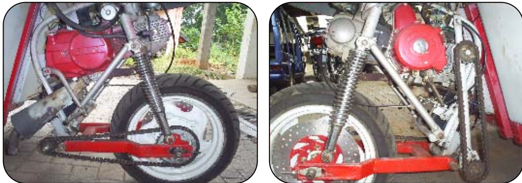
Gambar 18. Konstruksi sistem suspensi depan Micro Car
