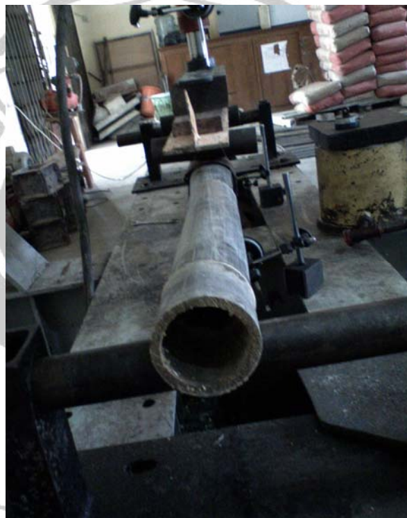
Gambar 5.2. Kerusakan Yang Terjadi Pada Bambu Kosong
