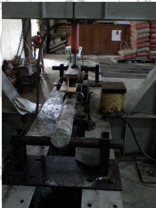
Gambar 6 Pengujian Bambu Dengan Isian Mortar
