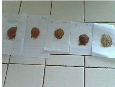
Gambar 5. Kulit kacang tanah yang telah direndam dengan NaOH 1,5, 2, 2,5 dan 5M dan kulit kacang tanah tanpa perendaman dengan NaOH (paling kanan)
