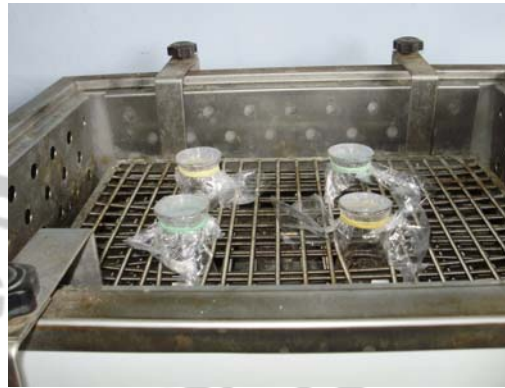
Gambar 2. Zat warna dan kulit tanah dishaker
