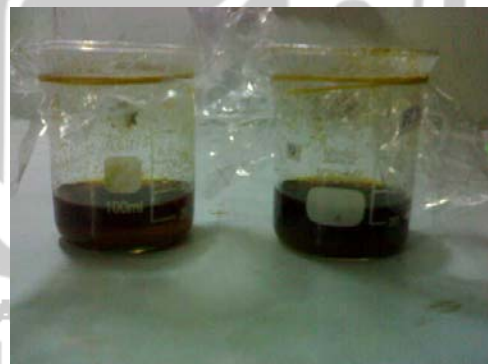
Gambar 4. Perendaman kulit kacang tanah dengan NaOH
