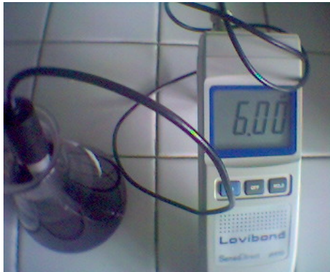
Gambar 1. Pengukuran pH kacang zat warna dengan pHmeter
