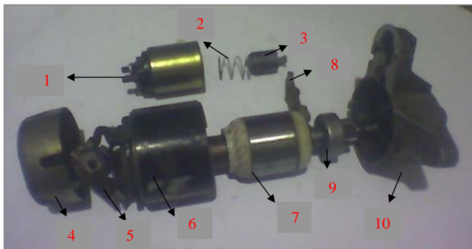
Gambar 19. Langkah Pembongkaran Motor Starter Tipe Konvensional
