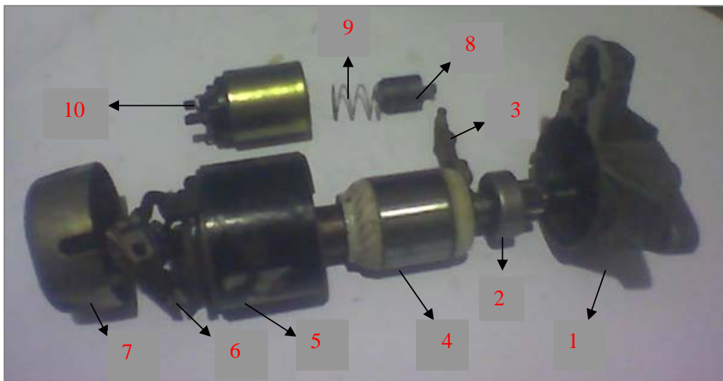
Gambar 31. Langkah Perakitan Motor Starter Tipe Konvensional
