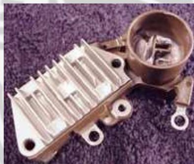
Regulator mengatur keduanya baik itu voltase aki dan voltase stator, dan tergantung dari kecepatan putaran mesin, regulator akan mengatur Kemampuan kumparan rotor untuk menghasilkan output Alternator.
