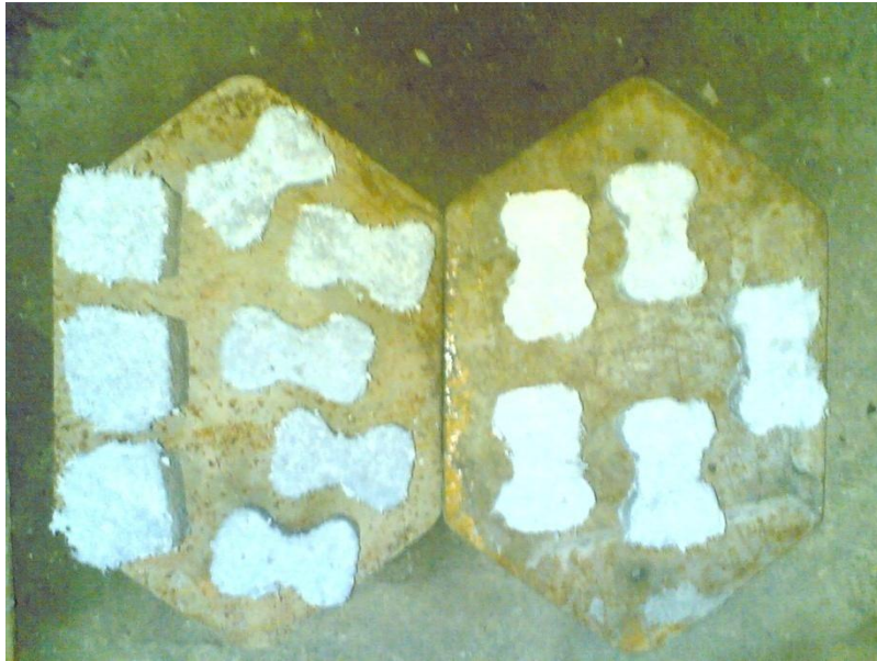
Gambar : Proses perawatan benda uji untuk uji kuat tekan dan kuat tarik
