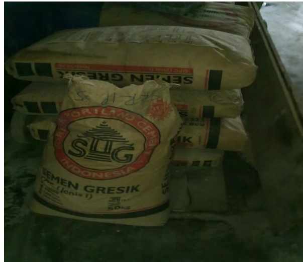
Gambar : Semen merk Gresik kemasan 50 kg yang digunakan dalam pembuatan mortar
