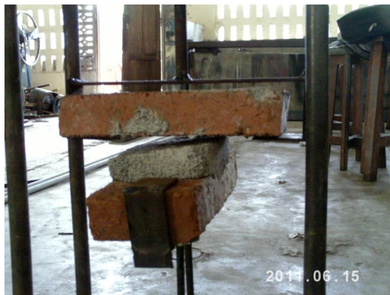
Gambar : Proses Pengujian Kuat Rekat Mortar
