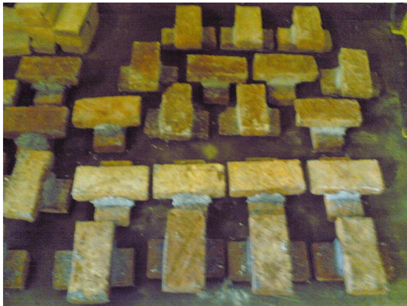
Gambar : Proses perawatan benda uji untuk uji kuat tekan dan kuat tarik
