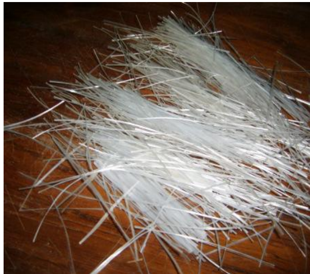
Gambar : Serat Roving yang digunakan dalam pembuatan mortar
