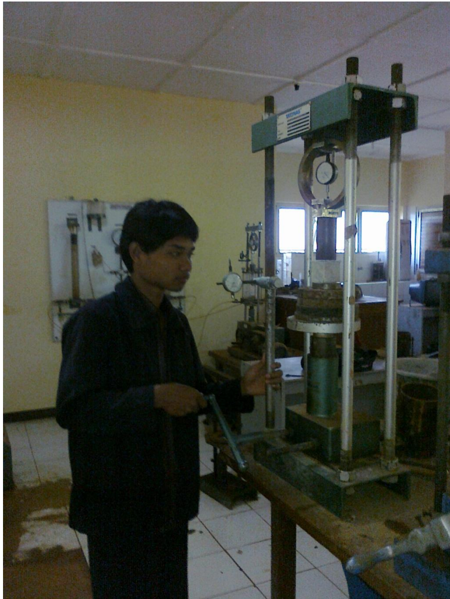
Gambar : Proses Pengujian Kuat Tekan Mortar
