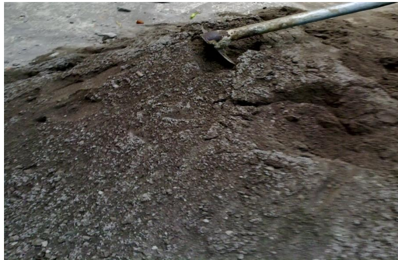
Gambar : Pasir muntilan yang digunakan dalam pembuatan mortar
