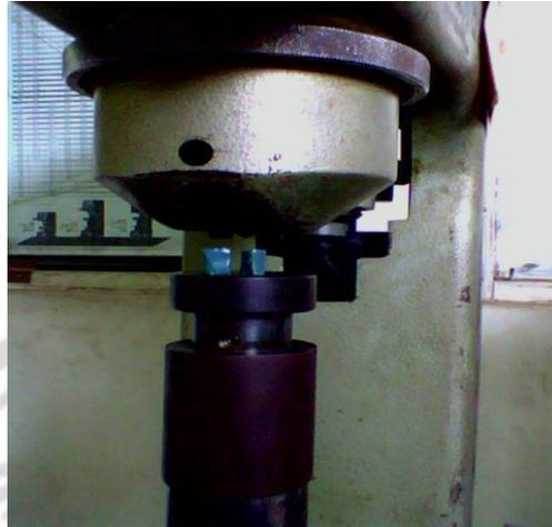
Gambar 2.7. Uji kekerasan dengan metode *rockwell*
