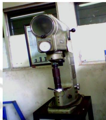
Gambar alat uji kekerasan Rockwell di teknik mesin POLINES
