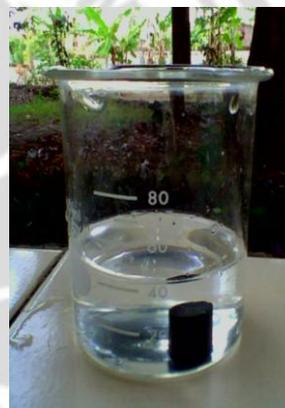
Gambar pengukuran massa dan volume sampel
