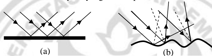
Gambar 1. (a) pemantulan teratur dan (b) pemantulan baur
