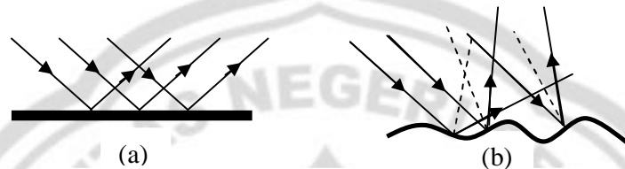
Gambar 1. (a) pemantulan teratur dan (b) pemantulan baur
