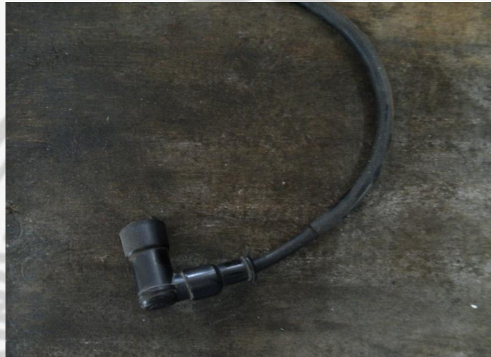
Gambar 23. Kabel tegangan tinggi.
