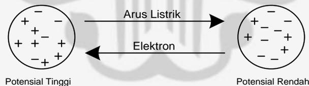
Gambar 1.1 Aliran elektron
