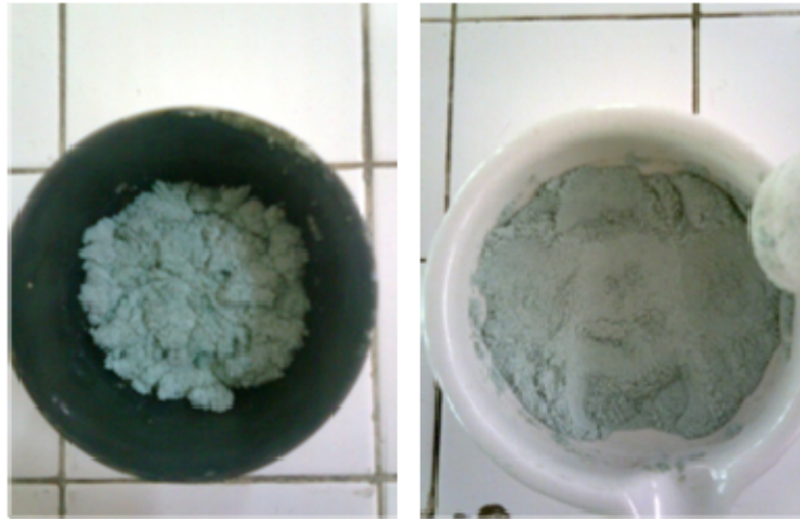
Gambar 4. Hasil Furnace Abu Layang/NaOH sebelum dan setelah di haluskan
