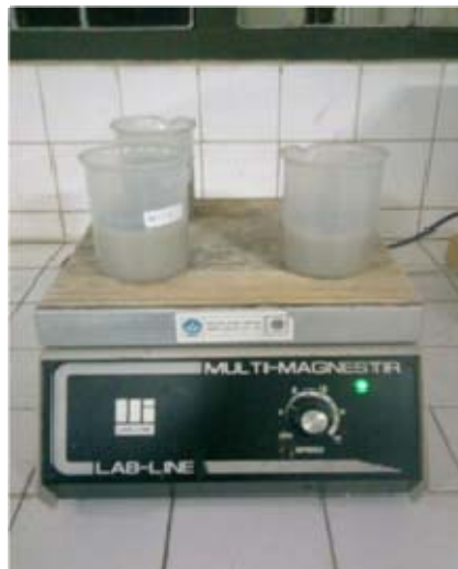
Gambar 5. Proses stirrer Abu Layang
