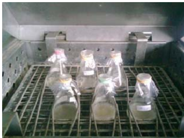
Gambar 9. Proses Adsorpsi Zeolit Sintesis pada Limbah di shaker selama 4 jam
