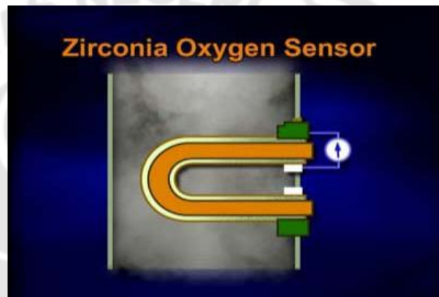
Gambar 6. ZrO_2 Oxygen Sensor
