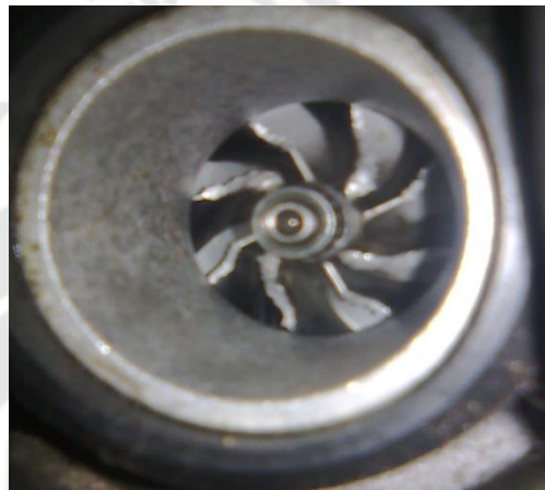
Gambar Kerusakan Pada Bilah Turbo
