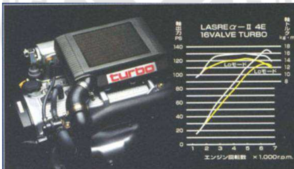
Gambar 23. Grafik Hasil Pengukuran Torsi Dan Daya Pada Mesin Toyota Starlet Standart Pabrikan ( http://s0nic.net )
