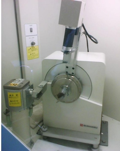
Foto alat karakterisasi XRD Lab X XRD 6000 SHIMADZU
