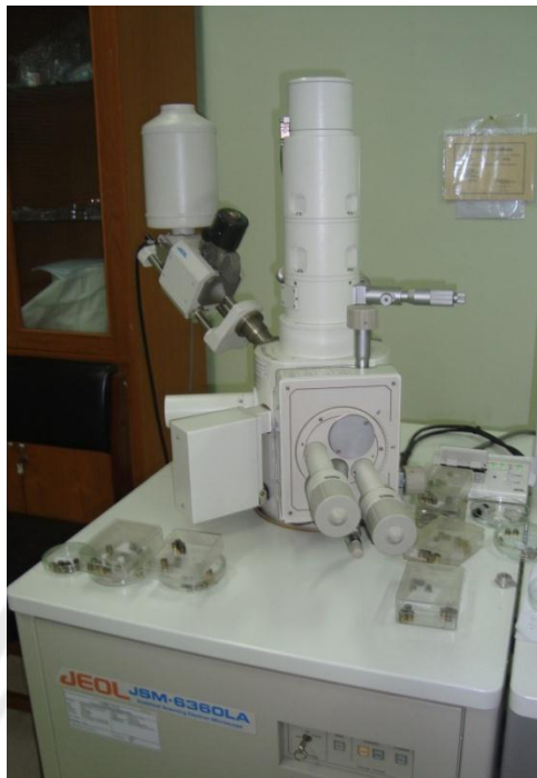
Foto alat karakterisasi SEM dengan menggunakan JEOL JSM-6360LA
