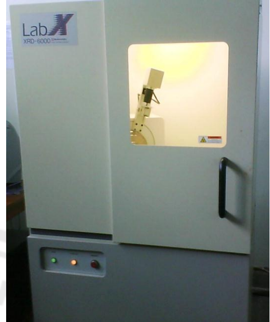
Foto alat karakterisasi XRD Lab X XRD 6000 SHIMADZU
