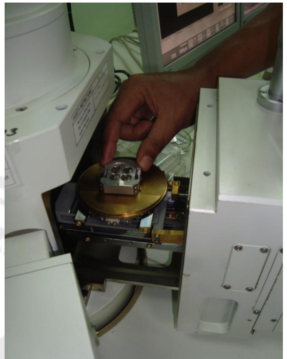
Foto alat karakterisasi SEM dengan menggunakan JEOL JSM-6360LA
