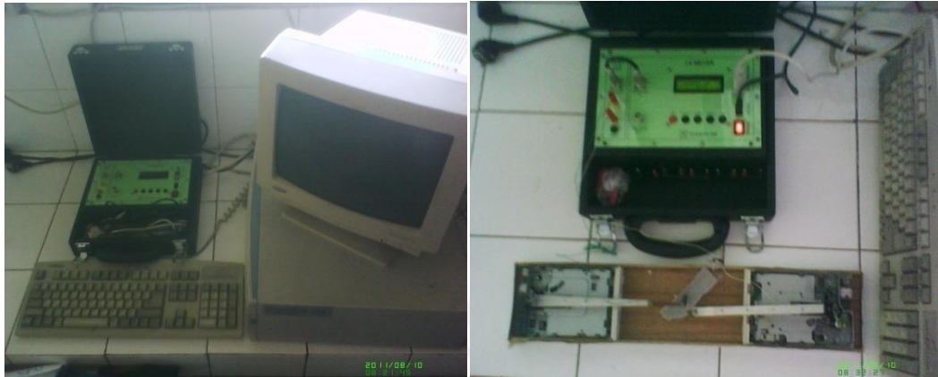
Foto karakterisasi I-V dengan menggunakan I-V Meter ELKAHFI 100
