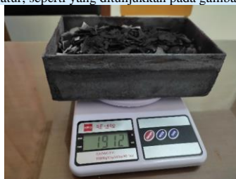
Gambar 3. Pengukuran berat arang tempurung kelapa
