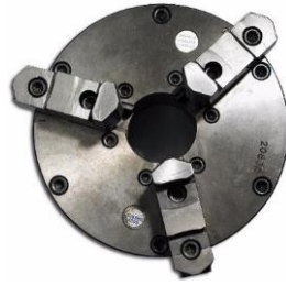
Gambar 2.3 Pencekam dengan tiga rahang ( Three Jaw Chuck )
