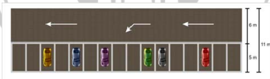
Gambar 3.1 Posisi parkir kendaraan satu sisi membentuk sudut 90^\circ
