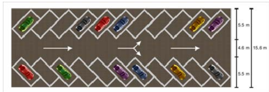
Gambar 3.4 Posisi parkir kendaraan dua sisi membentuk sudut 30^\circ , 45^\circ , 60^\circ
