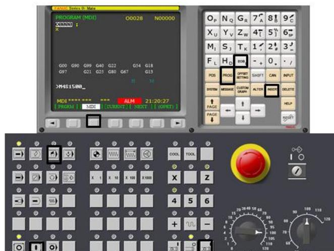
6. Untuk mensetting tool yaitu dengan menekan Tool mangement > Tool no. 1 > Add Tool Turret > Tool Station 1, demikian juga untuk tool 2 dengan Tool Station 2. Lalu mensetting letak tool dengan cara, klik Parameter Setup > Tool Turret Position > Rear Mounting Tool Turret
