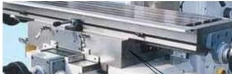
Gambar 2.11 Sadel Mesin Frais
