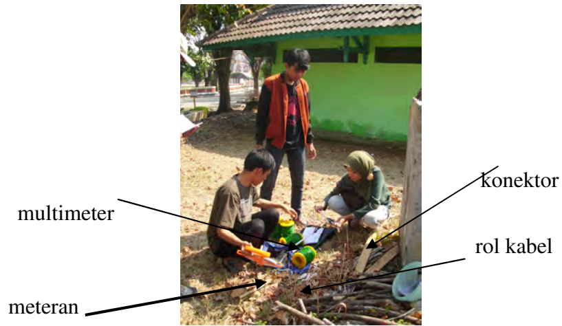
Gambar 17. Persiapan alat berupa dua kabel yang ujungnya dipasang konektor
