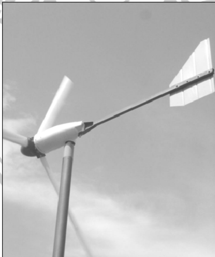
Gambar 4. kincir angin yang dapat menghasilkan listrik hingga 1 KW
