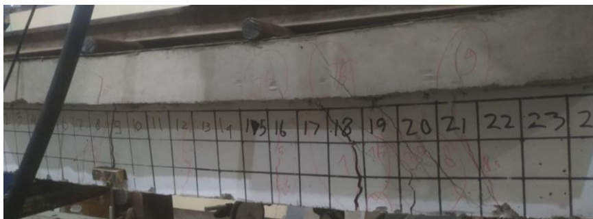
Gambar 4.20 Pola Retak Balok Perkuatan
