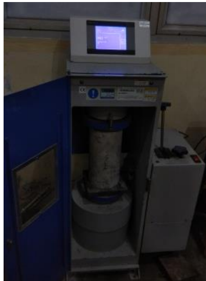
Gambar 4. 3 Uji Kuat Tekan
