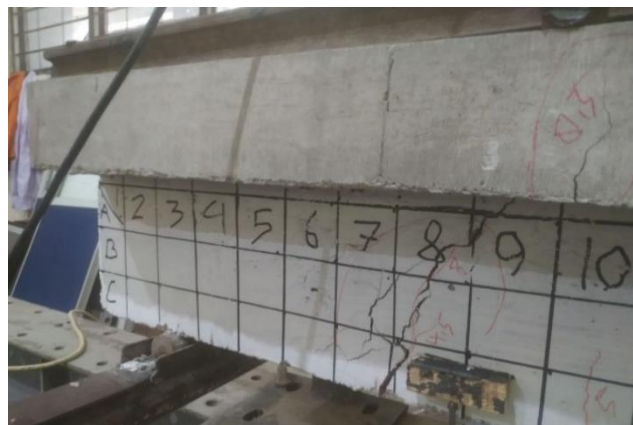
Gambar 4.18 Retak Awal Balok Perkuatan
