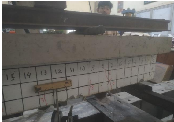
Gambar 4.17 Retak Awal Balok Kontrol
