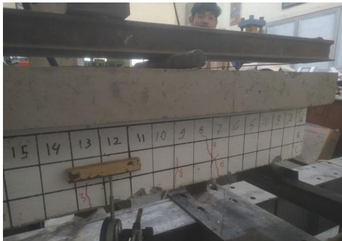
Gambar 4. 16. Retak Awal Balok Kontrol
