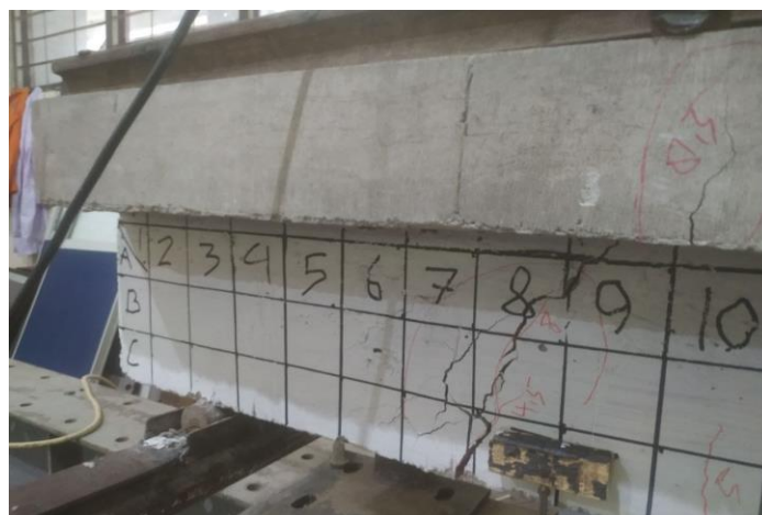
Gambar 4. 17. Retak Awal Balok Perkuatan 2(1)
