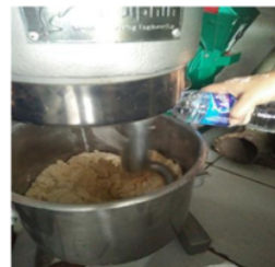
Gambar 3. Uji coba hasil rancangan alat pencampur ( mixer ) adonan donat kentang
