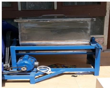
**Gambar 2. . Hasil rancang bangun alat pencampur**
