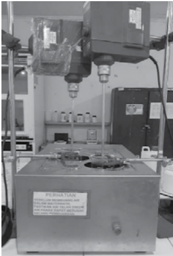
Gambar 4.7 Skema Alat Pengadukan & Pemanasan pada Pembuatan Sabun Mandi Padat Transparan
