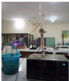
Gambar 4.3. Rangkaian Alat MAE (Sumber: Dokumentasi Pribadi)
