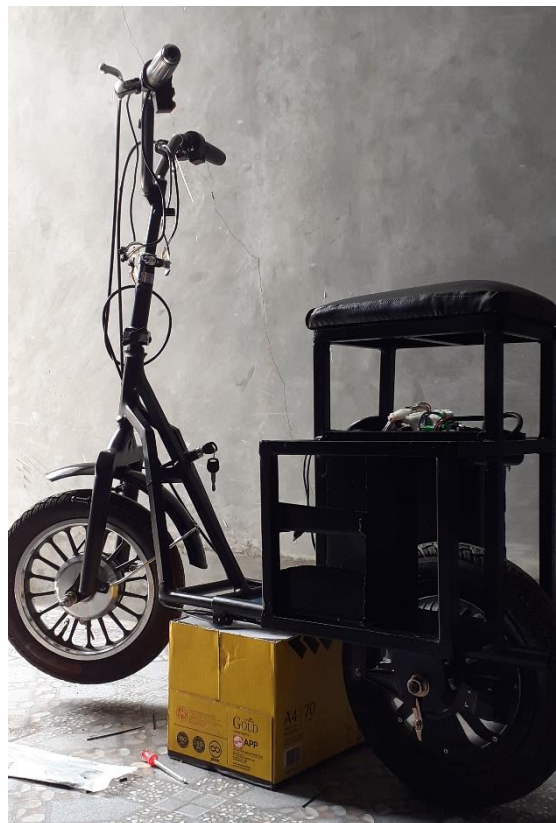
Gambar 5.12. Penyetelan kabel dan kontroller
