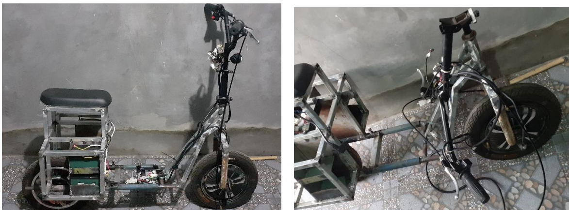
Gambar 5.8 uji coba perakitan sepeda listrik.
