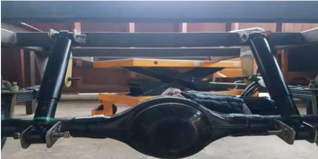
Pemasangan shock absorber belakang
