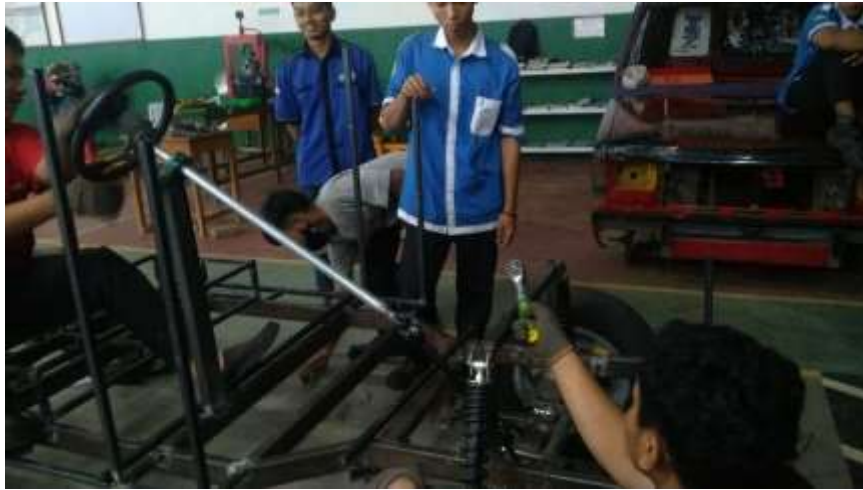
Pemasangan sistem Steering
