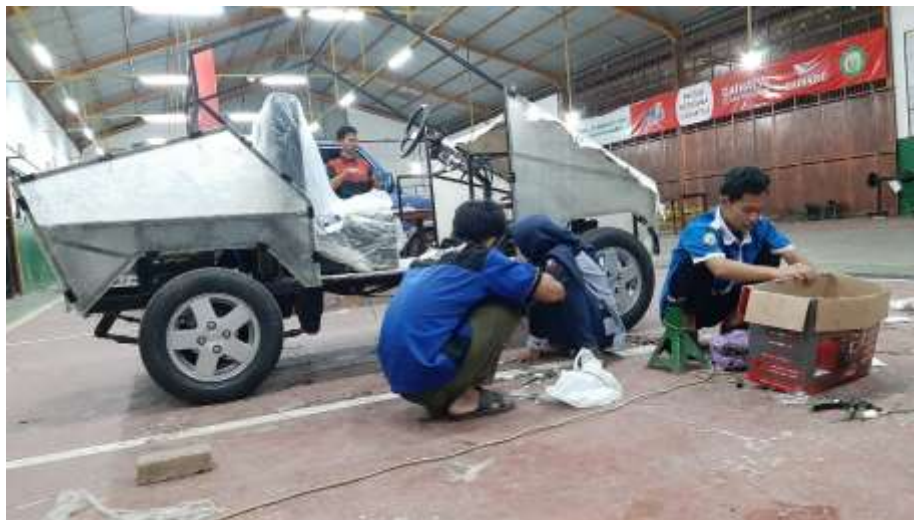
Gambar 5.17. Proses pembelajaran pembuatan bodi kendaraan
