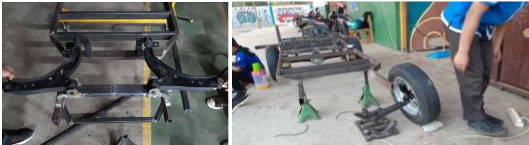
Gambar 5.8 Proses pembelajaran pembuatan suspensi depan
