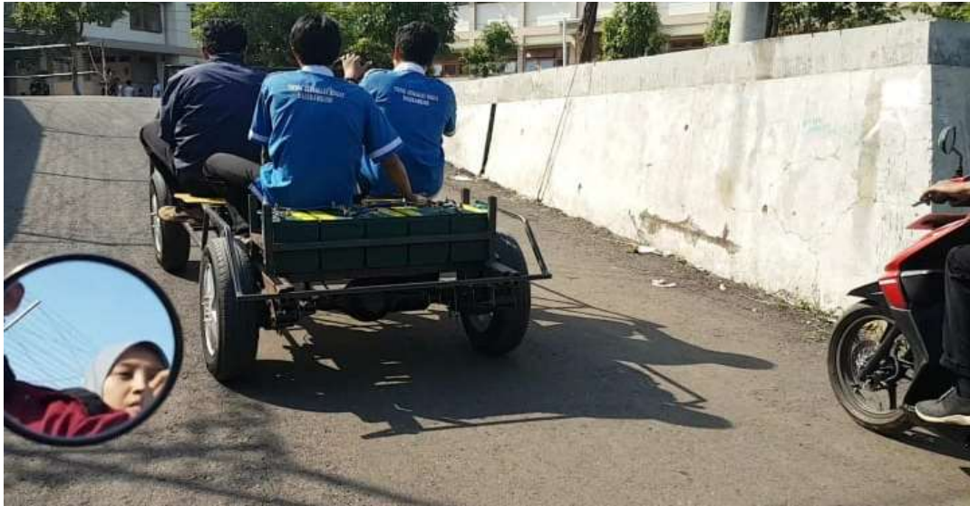
Gambar 5.13. Uji Coba jalan menanjak kemiringan 40 derajat
