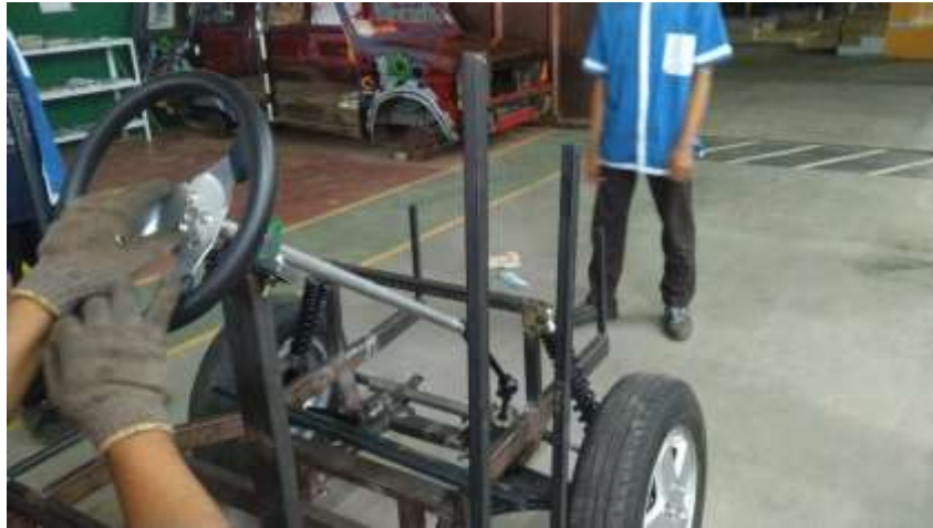
Gambar 5.9. Proses pembelajaran pembuatan sistem kemudi
