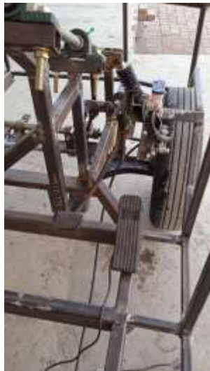
Pemasangan rem dan pembuatan kursi penumpang
