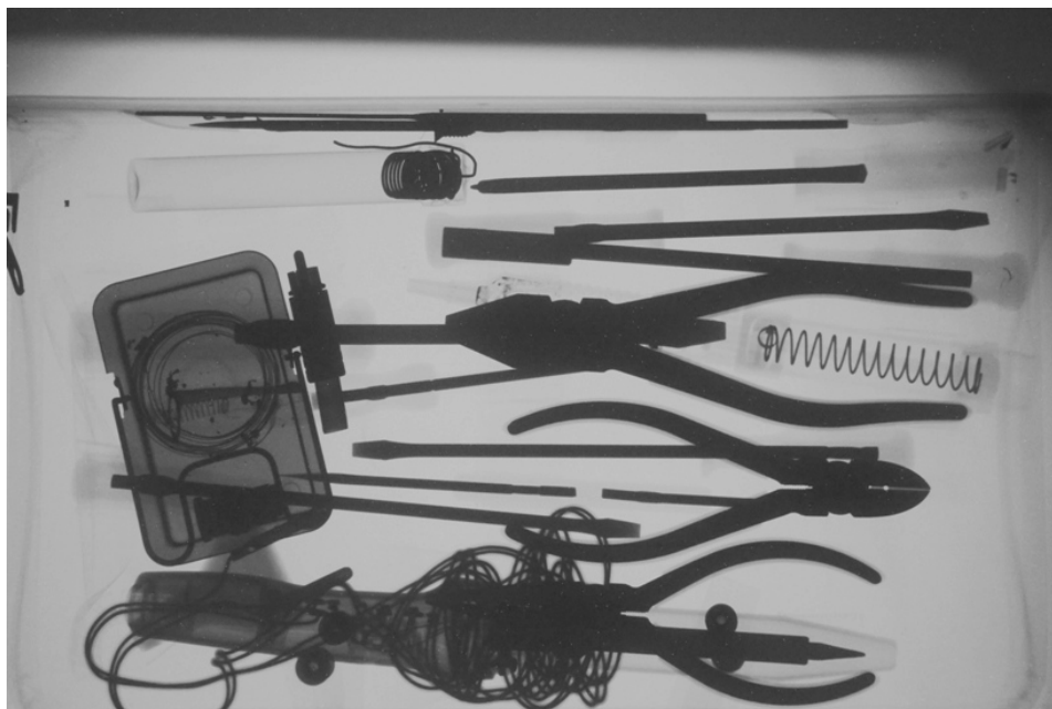
Gambar 8. Model sistem RD sebagai metal detector untuk mendeteksi logam di dalam koper tertutup.
