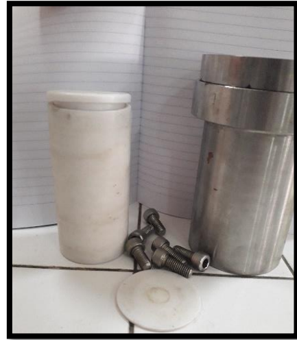
Suspensi ZnO dimasukkan dalam rangkaian alat hidrotermal
