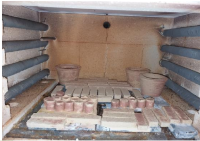
Gambar 8.12. Proses Sintering pada Spesimen Crucible
