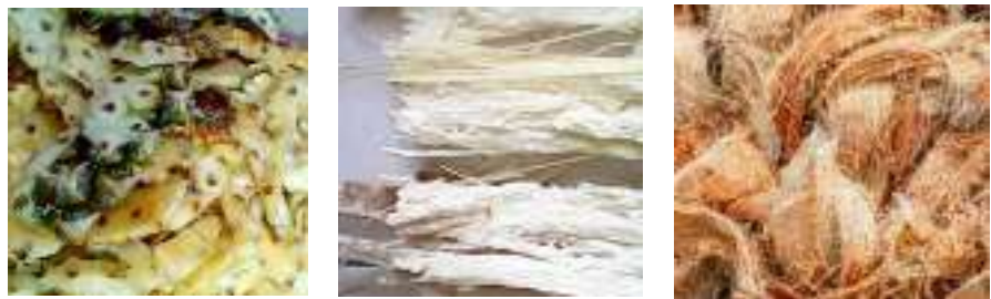
Gambar 4.3 (a) Ampas Nanas (b) Ampas Tebu dan (c) Serabut Kelapa Sebagai Bioadsorben Minyak Jelantah
