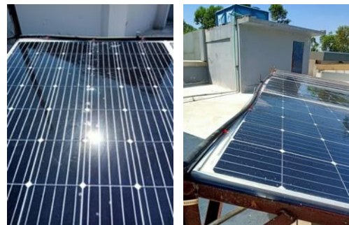
Gambar 4. Modul Panel Surya Ketika Diberi Pendingin
