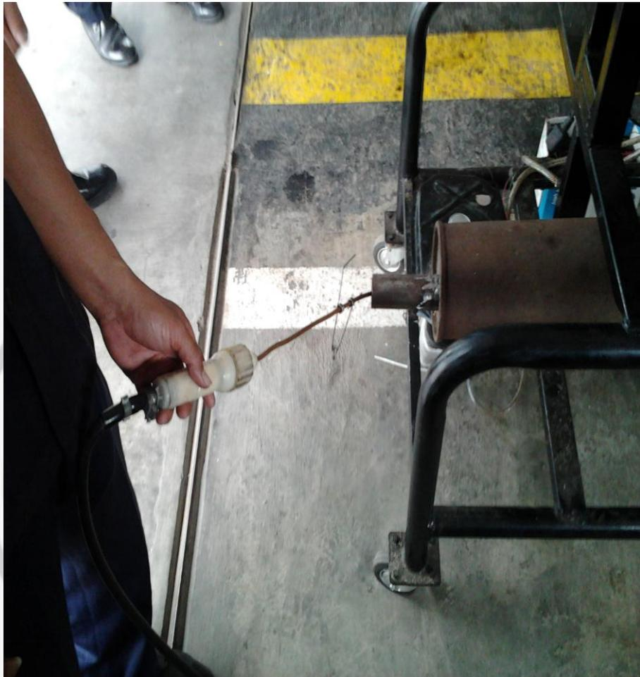
Foto Pengujian emisi gas buang
