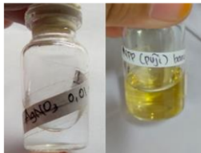
Gambar 1. Perubahan warna dari jernih larutan \text{AgNO}_3 menjadi kuning pucat pada pembentukan NPP
