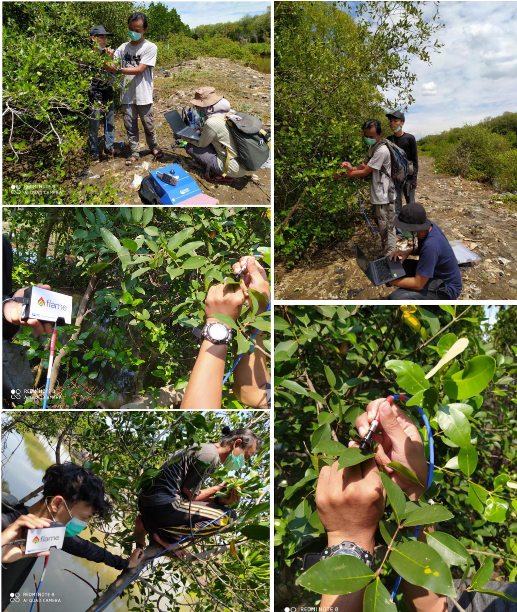
Gambar 3. Pengukuran Nilai Spektral Mangrove Menggunakan Spektrometer
