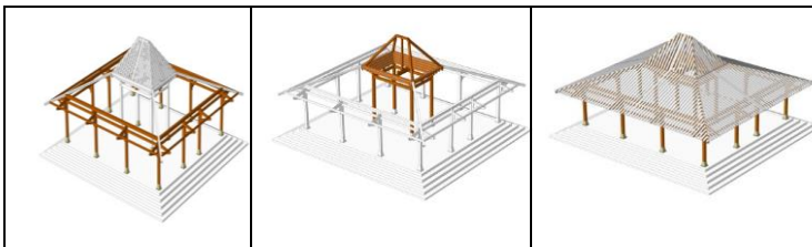
Gambar 13: Konstruksi ruang pendopo (sumber pribadi)
