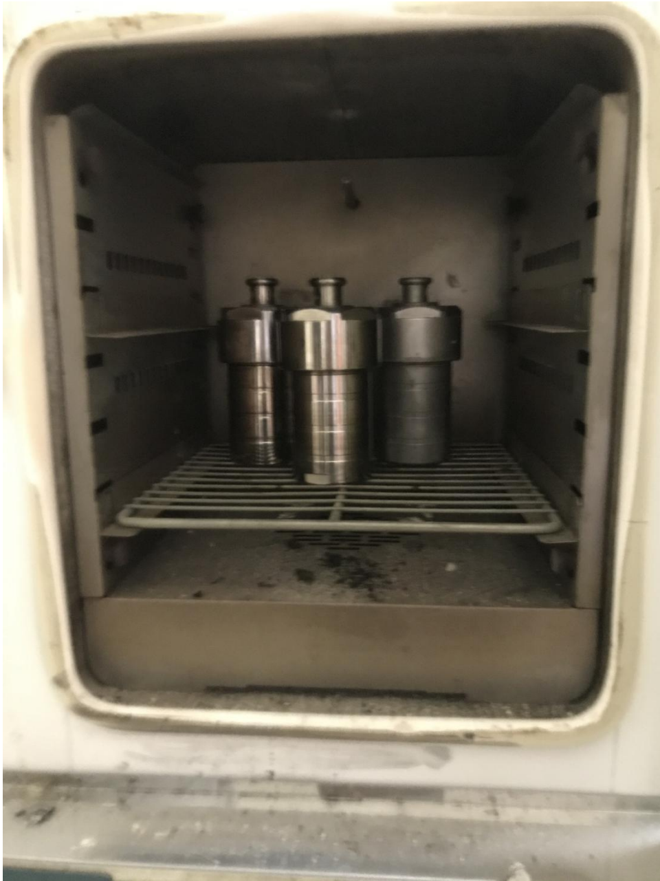
Memasukkan vial ke dalam oven untuk proses hidrotermal.
