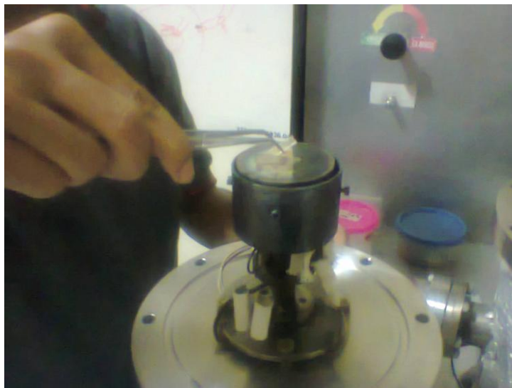
Gambar L2.3: Pemasangan subtrat ITO pada holder sample sebelum proses penumbuhan struktur-hetero CdTe/CdS:Zn
