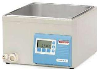
Fungsi utama water bath adalah untuk menciptakan suhu yang konstan dan digunakan untuk pemanasan, inkubasi dan penguapan.
