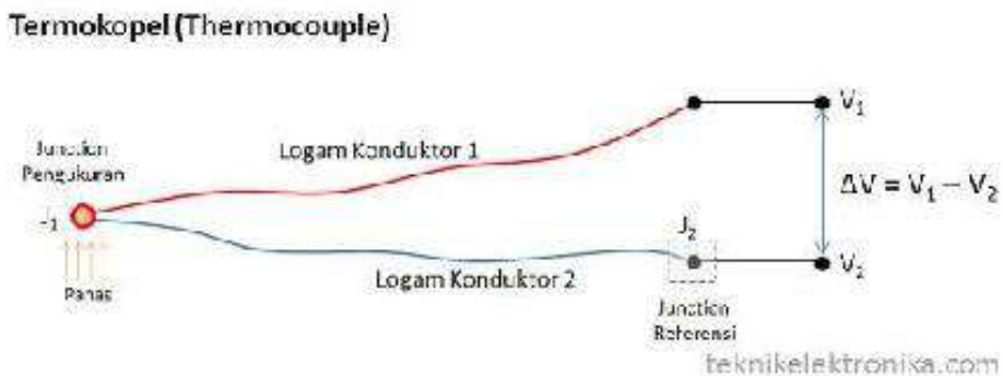
Gambar IV.6 Cara Kerja Thermocouple
