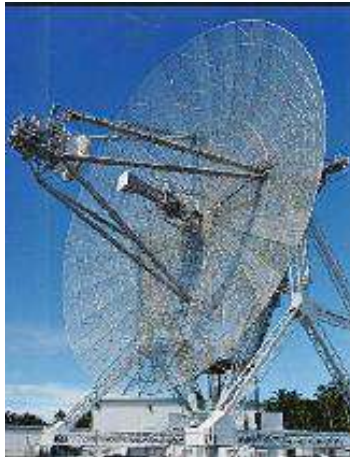
Gambar VI.5 ALTAIR Radar. radar jarak jauh mendeteksi objek di luar angkasa
