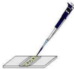
Gambar 10. Penetesan suspense pada hemositometer
