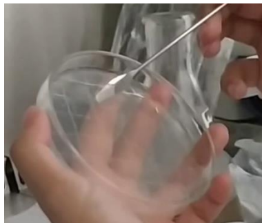
Gambar 15. Pemotongan slide PDA 2x2 cm menggunakan spatula.
