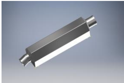
Gambar 6.32 Desain silencer terpasang kedua tutup
