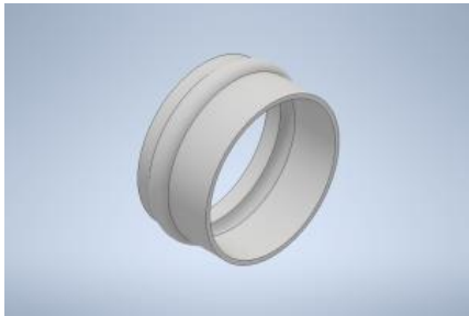
Gambar 6.14 Desain setelah forming garis timbul
