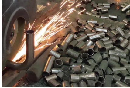
Gambar 6.9 Pemotongan bagian pipa yang tidak terpakai
