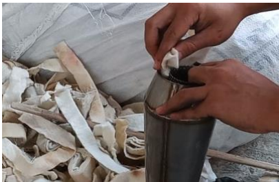
Gambar 6.38 Proses memasukkan glasswool
