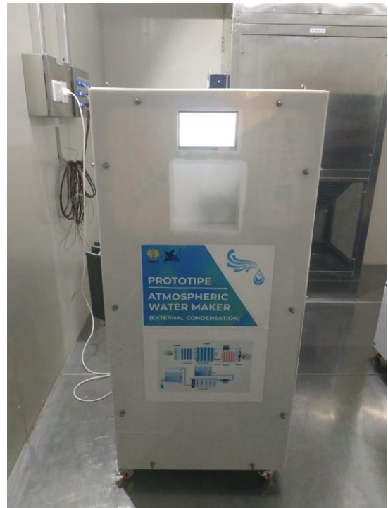
Gambar 1. Produk Atmospheric Water Maker Tampak Depan
