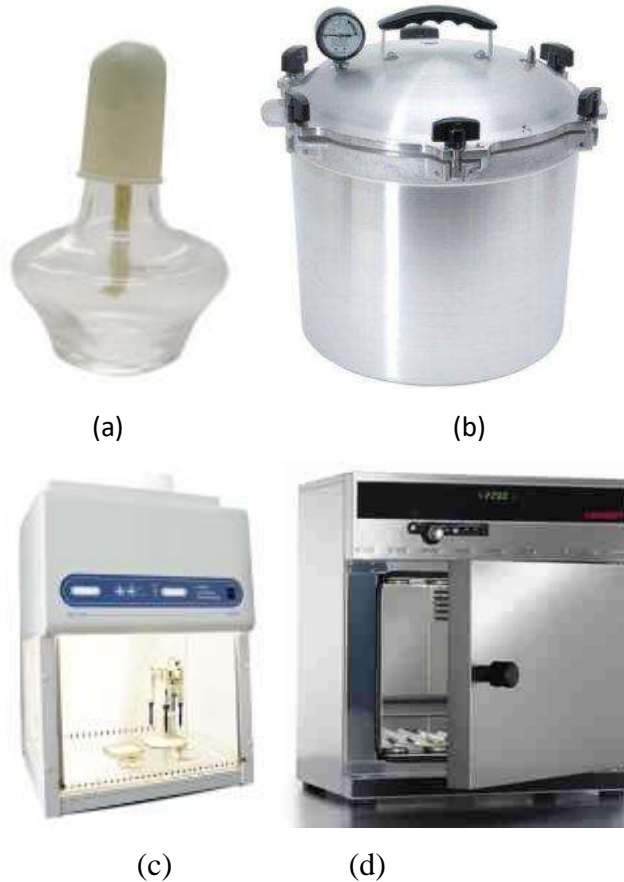
Gambar 1.2 (a) pembakar spiritus, (b) autoklaf, (c) Laminar air flow, dan (d) Oven
