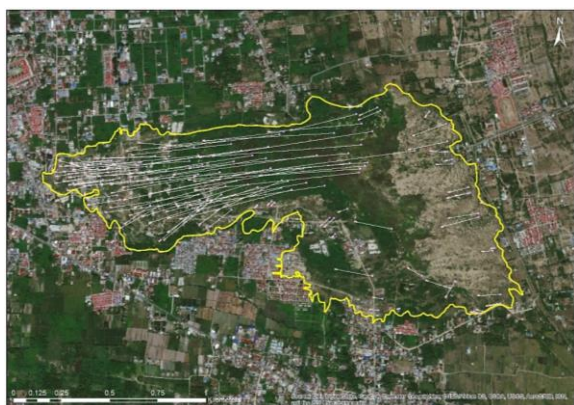
圖十 2018.9.28地震造成Petobo地區地表水平位移
