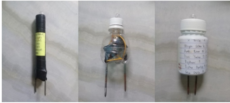
Gambar 1. Hasil alat uji daya hantar listrik portabel
